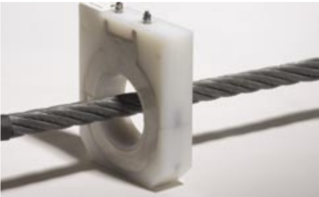
Der robuste Sendekern wird in der Sendestation für die induktive Einkoppelung auf das Förderseil benützt.
