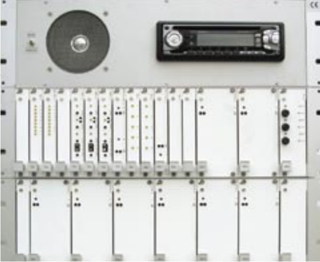
Modular aufgebautes Bedien- und Sendegerät in 19''-Racktechnik. Platzbedarf 9 HE, einfacher Einbau in bestehende Anlagen möglich.
