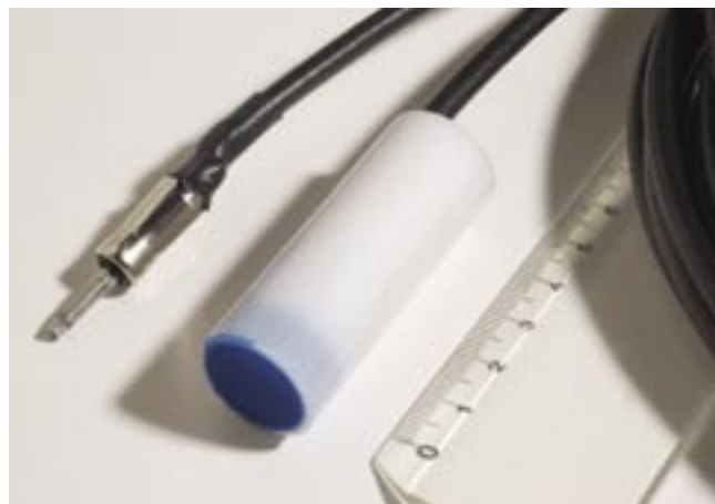
Klein aber fein - für den Empfang in der Kabine steht eine robuste, wetterfeste Kunststoffantenne mit vergossenem Ferritkern zur Verfügung. Diese Antenne nimmt die elektromagnetische Strahlung vom Förderseil auf.
