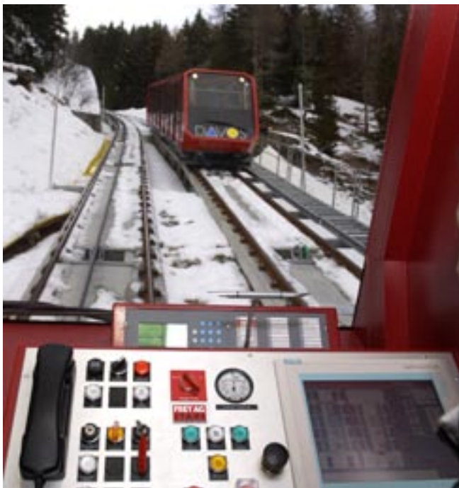
200 Personen pro Wagen werden mit 10 m/s in 253 s von 1557 m auf 2218 m gebracht. Dazu ist eine Antriebsleistung von 1250 kW erforderlich.
