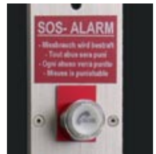
In jedem Wagenabteil stehen den Fahrgästen Alarmschalter zur Verfügung. Damit wird der Wagenführer alarmiert.
