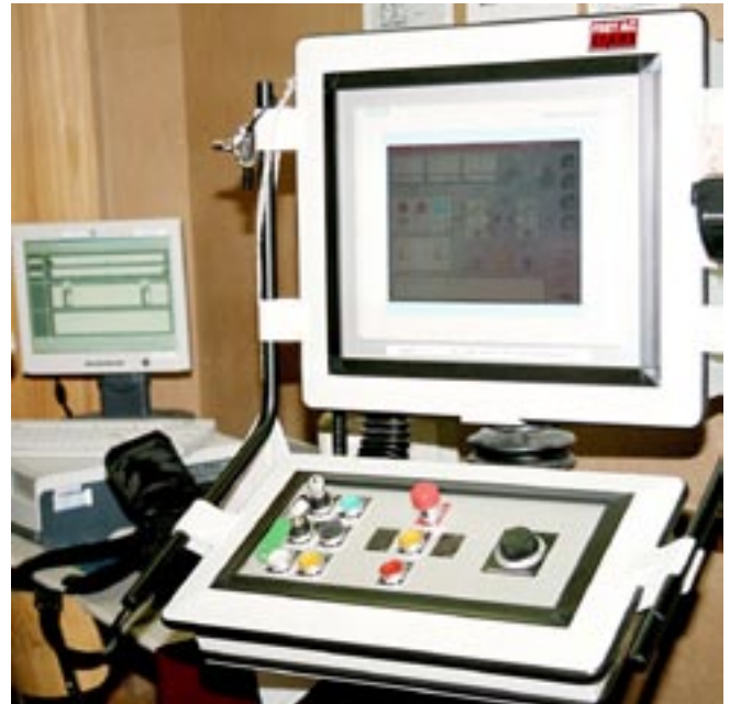
Betriebssteuerung (rechts) und Visualisierung (links) sind bewusst getrennt, um den Betriebsmonitor so einfach wie möglich zu gestalten.
