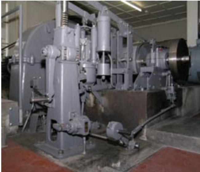
Sicherheitsbremse wird mit einem Haltemagneten aus den 30-er Jahren offen gehalten.
