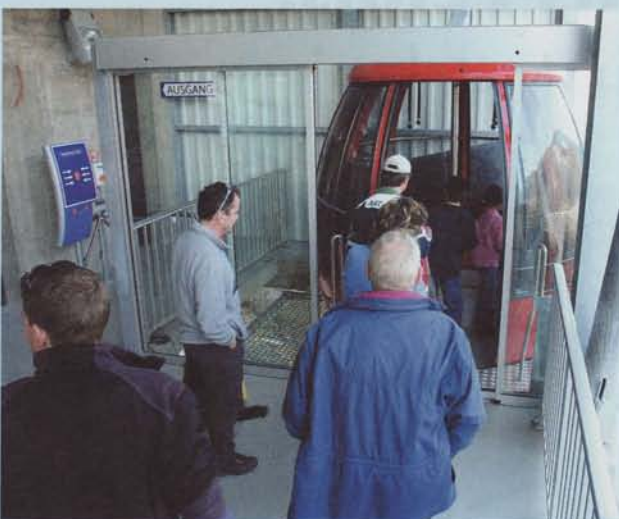
Glas-Schiebetüren geben den Zu- und Ausstieg an den Perrons automatisch frei.
