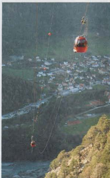
Bergab öffnet sich jäh das Tal ab Stütze 1. Die dort installierte Rettungsbahn erreicht beide Kabinen.
